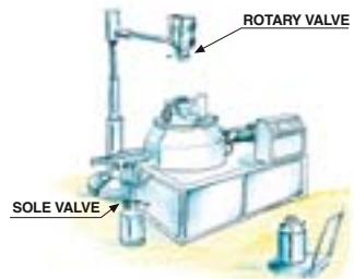
La **SOLE VALVE** rappresenta quanto di meglio è disponibile in una valvola a farfalla concepita per controllare il flusso delle polveri e granuli. È leggera, maneggevole e facile da smontare e pulire.
