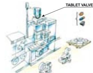
La **TABLET VALVE**. La farfalla in silicone permette di aprire e chiudere la valvola senza alcun danno al prodotto. La **TABLET VALVE** è facile da smontare e pulire.
