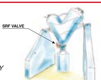
La **SANITARY ROTARY VALVE** è caratterizzata da un doppio rotore. Il rotore più grande permette il trasferimento di grossi quantitativi di prodotto mentre quello più piccolo permette di raggiungere il quantitativo richiesto. La **SANITARY ROTARY VALVE** è facile da smontare e da pulire.
