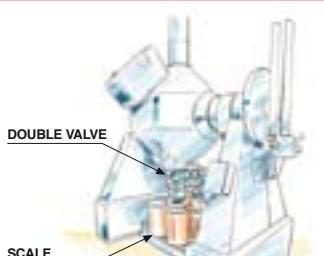
La **DOUBLE VALVE** è costituita da un corpo con una grande farfalla che al suo interno ha un piccolo rotore. La farfalla trasferisce una grossa quantità di prodotto mentre il rotore scarica il peso totale pre-regolato. La valvola si smonta e si pulisce facilmente.
