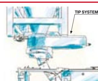
Il **TIP 0 (ZERO) SYSTEM** è un sistema di carico/scarico progettato appositamente per effettuare un trasferimento di prodotto tra due macchine o tra macchina e Bin o tra Bin e macchina, limitando il contatto del prodotto da trasferire con l'ambiente di lavoro.
