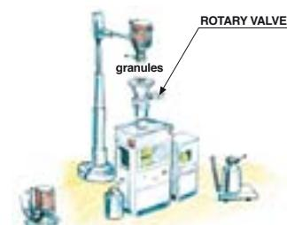
La **ROTARY VALVE** è indicata per applicazioni dove è richiesto il flusso continuo per l'alimentazione di polveri e granuli nelle macchine di processo. La valvola si smonta e si pulisce facilmente.
